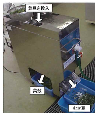
写真 むき豆加工に使用した蒾むき機（PSS販売株式会社製 型式P-78）
