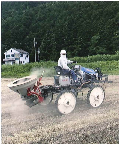
写真 転炉スラグの散布作業
