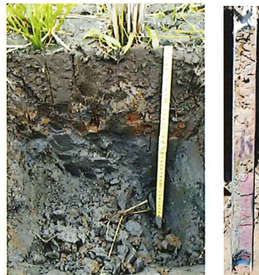
写真 簡易土壌調査の様子(左) 検土杖で採取した土壌(右)
